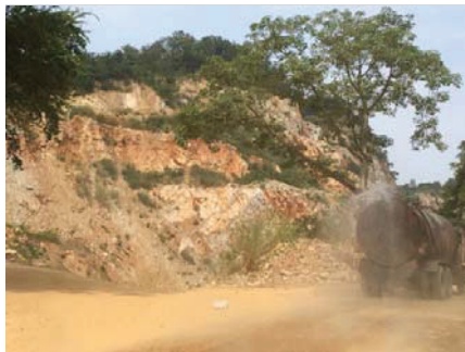
รูปที่ 2-17: การฉีดพรมน้ำบริเวณหน้าเหมือง
